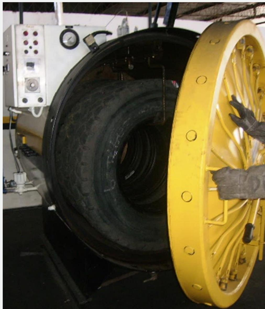
VULCANIZAÇÃO EM AUTOCLAVE DESMONTADO
